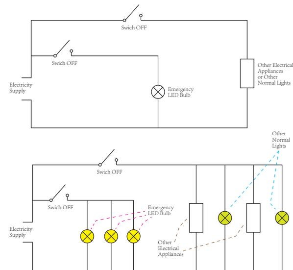
2. **Méthode de câblage inadaptée:** un même commutateur ne peut pas gérer les ampoules classiques ou les appareils électriques et les ampoules LED de secours.
